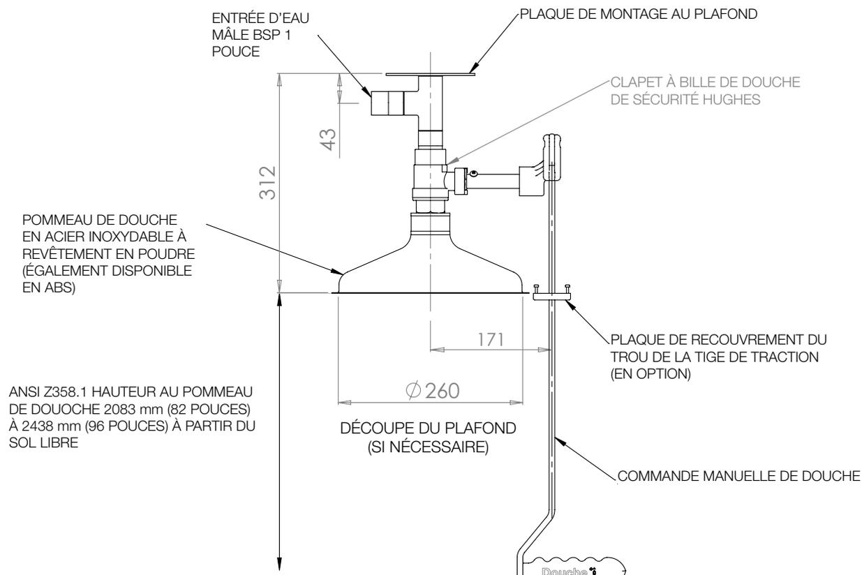
3 TROUS Ø9 POUR BOULONS DE FIXATION SUR 105 PCD
